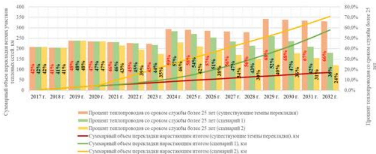
Рисунок 1.7 – Ожидаемая динамика старения водяных тепловых сетей ООО «ТСК Новая Москва» в зависимости от различных объемов их реконструкции
