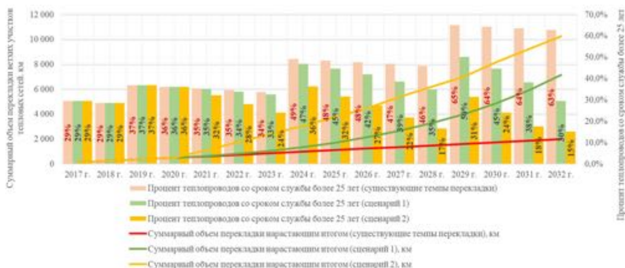
Рисунок 1.3 – Ожидаемая динамика старения водяных тепловых сетей ПАО «МОЭК» в зависимости от различных объемов их реконструкции
